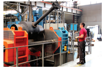
Тестирование шаровых кранов
